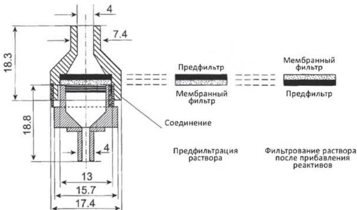
Рисунок 1 – *Прибор для определения тяжёлых металлов методом 8*
